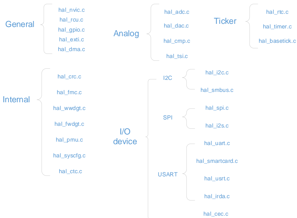
图 2-1. GD32F3x0 HAL 固件库实现框架
